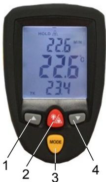
1 - Bouton Haut. Il permet d'incrémenter l'émissivité et les seuils d'alarme haute et basse et de passer à la valeur suivante enregistrée. Il permet également de naviguer entre MAX, MIN, AVG, DIF et LOG.
